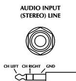
**AUDIO INPUT (STEREO LINE) connector:** 6,3 mm jack
