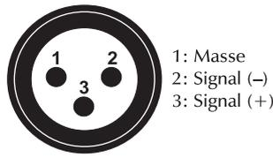
Wenn Sie die empfohlenen FUTURELIGHT-Projektoren verwenden, können Sie den DMX-Ausgang des Controllers direkt mit dem DMX-Eingang des ersten Gerätes der DMX-Kette verbinden. Sollen Projektoren mit anderen DMX-Ausgängen angeschlossen werden, müssen Adapterkabel verwendet werden.
