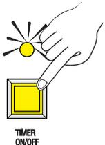
Im Timer-Betrieb stößt die Nebelmaschine automatisch Nebel aus. Die Zeitintervalle, die Nebeldauer und das Nebelvolumen lassen sich einstellen.
