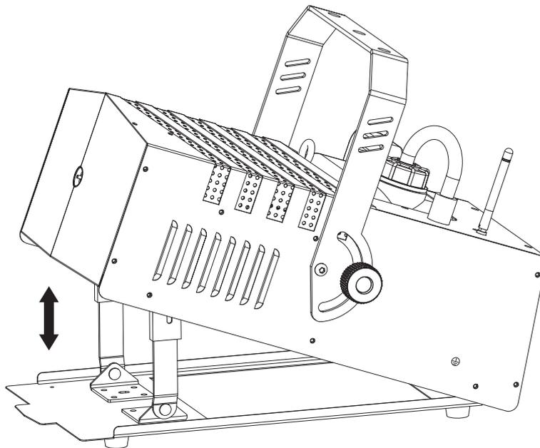
Der Ausstoßwinkel kann über die ausziehbaren Standbeine verstellt werden. Es sind fünf Stufen vorhanden.
