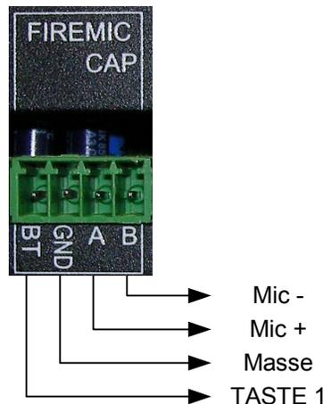
Weitere Hinweise zur Installation der Mikrofone finden Sie in der Bedienungsanleitung zur MEVAC-4.
