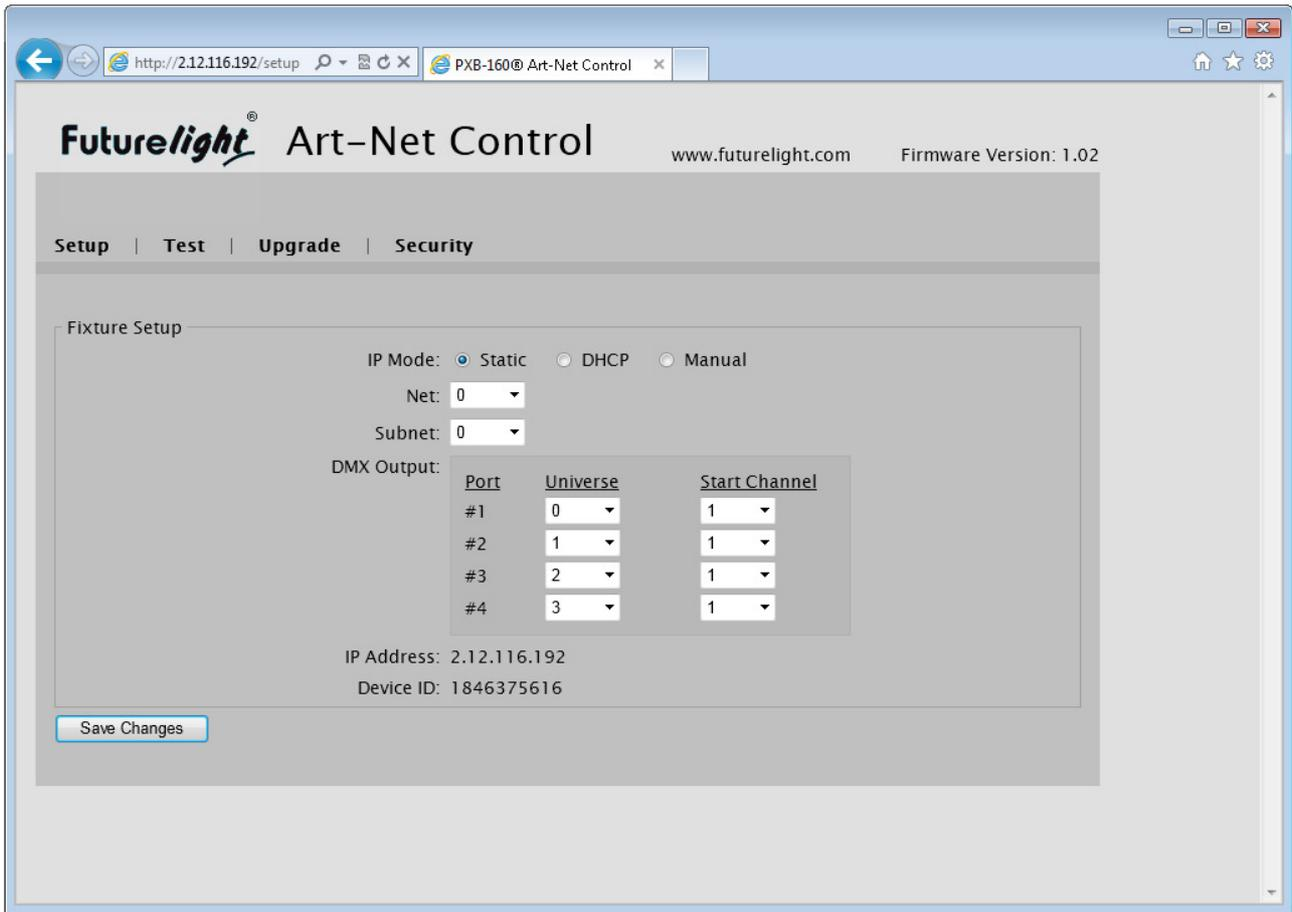
Die LED PXB-160 Artnet Bar verfügt über eine integrierte Webschnittstelle, mit der sich das Gerät ohne den Einsatz einer Fremdsoftware auch über einen Standardbrowser fernsteuern lässt. Die Schnittstelle kann genutzt werden, um das Gerät zu konfigurieren, einen Funktionstest durchzuführen und die Firmware zu aktualisieren.
