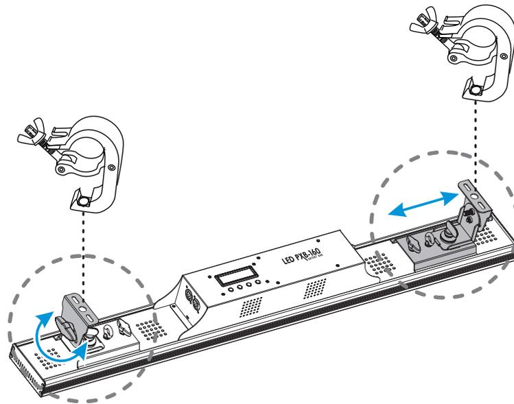
An der Leiste befinden sich zwei verstellbare Montagebügel, mit denen das Gerät an der Wand oder auf dem Boden befestigt werden kann. Die Bügel lassen sich beliebig nach links und rechts verschieben und im Neigungswinkel verstellen. Für die einfache Befestigung an einer Traverse können auch Haken über M10-Schrauben mit den Bügeln verschraubt werden.
