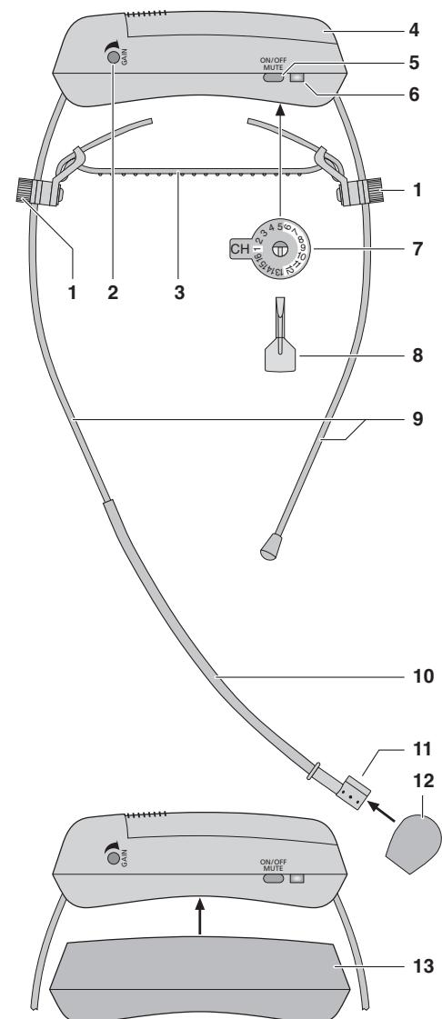
1 Ecrou de réglage pour la courroie de maintien (3)
