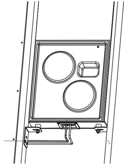
Respecter la phase, vérifier le bon serrage des bornes et bloquer le câble haut-parleur par agrafage/collage pour éviter tout risque de déconnexions ou vibrations.
