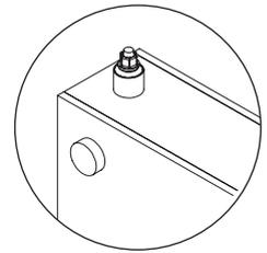
Visser les 4 silent blocks dans les inserts en bout de caisse et coller les patins en PVC sur les parois avant et arrière
