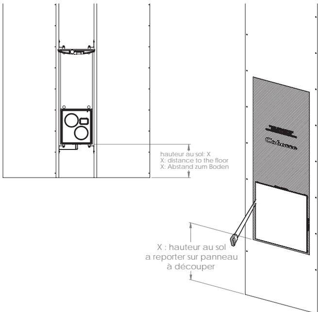
Positionner le bas du gabarit à la hauteur X du bas du panneau et découper l'ouverture pour la grille.
