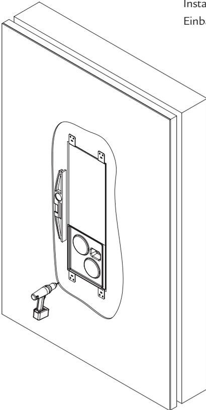
Fixation par l'avant et encastrement sans silent-blocks possibles.
