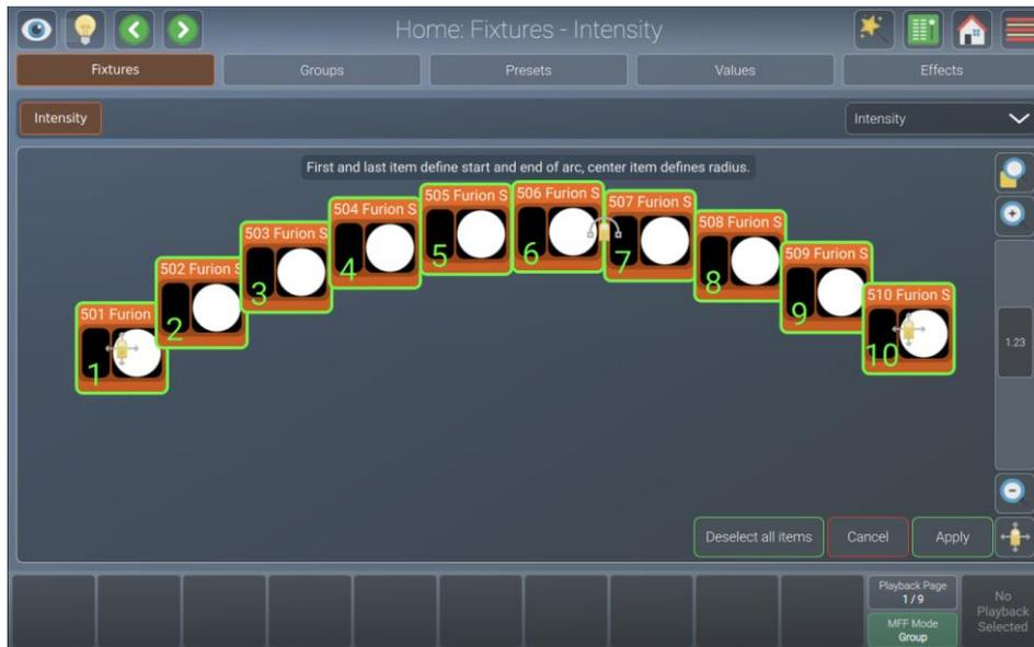
Abb. 95: Fixtures View - Bogen anordnen
