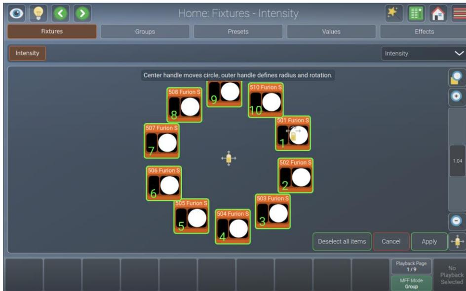
Abb. 97: Fixtures View - Kreisförmig anordnen
