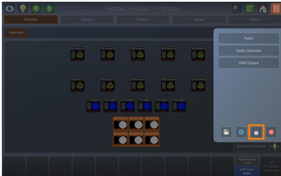
Abb. 184: Seitenmenü – Sperren der Konsole
