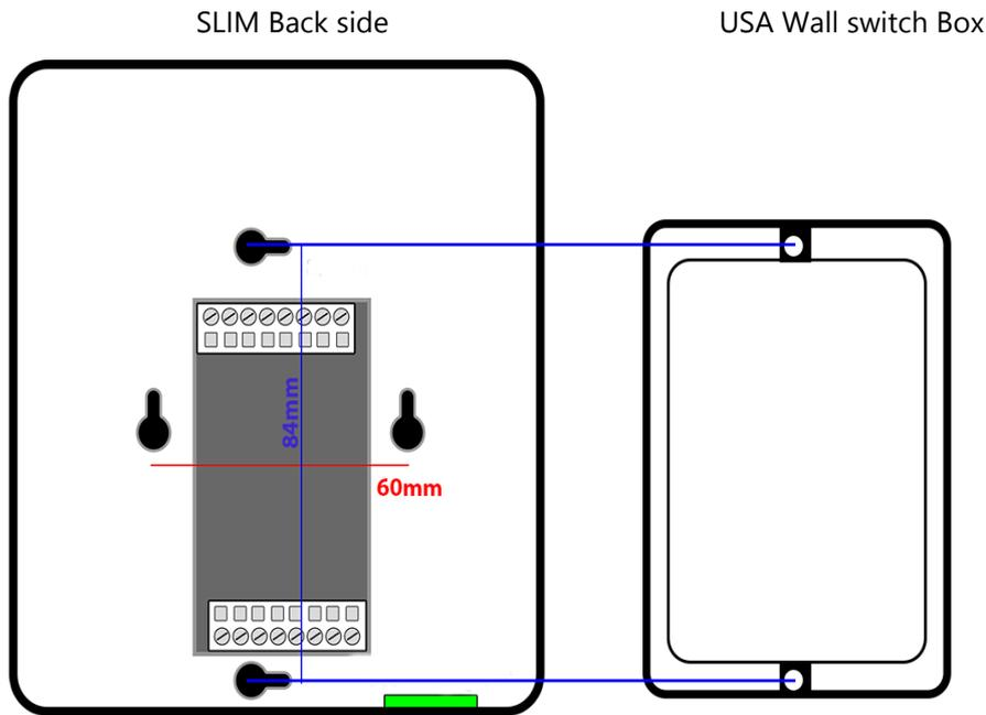
USE THE SCREWS OF THE WALL SWITCH BOX TO HOLD THE SLIM:
