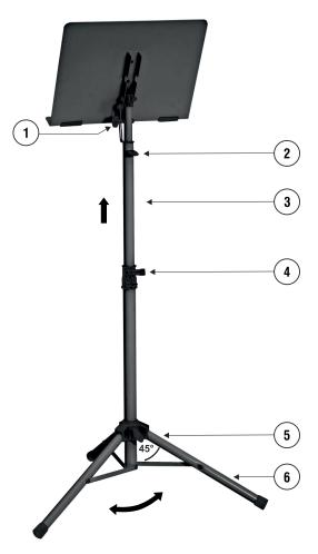
Öffnen der Stativbeine - Die Fixierschraube (5) der Stativbeine (6) lösen und diese nach außen ziehen. Die Fixierschraube wieder festziehen.
