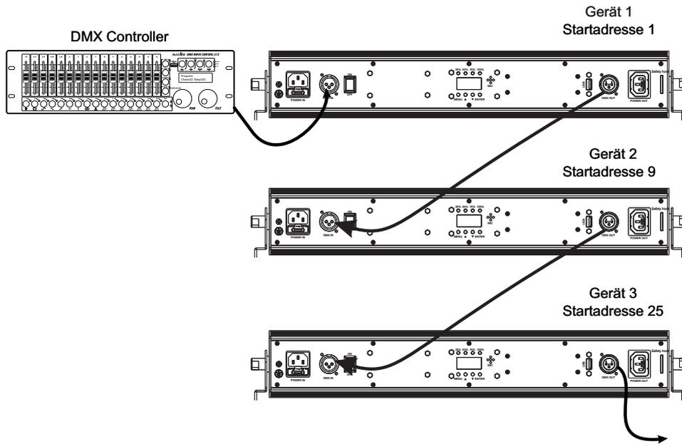
Für die Ansteuerung des Geräts per DMX512 ist eine Datenverbindung notwendig. Das Gerät verfügt dazu über 3-polige XLR-Anschlüsse.
