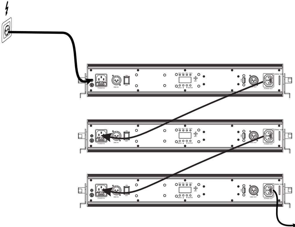
Das Gerät verfügt über ein Schaltnetzteil, das eine Netzspannung zwischen 100 und 240 Volt erlaubt.
