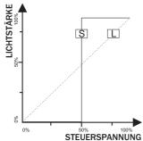
Hier können Sie die Übertragungscharakteristik des Dimmerpacks festlegen. Mit dieser Vorgabe bestimmen Sie, auf welche Weise Veränderungen der Steuerspannung (Fader-Bewegung am Controller) auf die nachgeschalteten Geräte übertragen werden. Auch hier kann je nach Modus die Dimmerkurve für alle Kanäle oder für jeden Kanal separat bestimmt werden.
