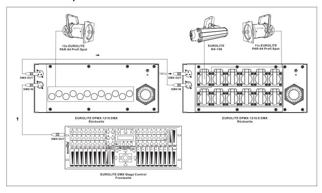
Anschlussbeispiel des EUROLITE DPMX-1216 DMX und EUROLITE DPMX-1216 S DMX mit dem Controller EUROLITE DMX Stage Control, den Scheinwerfern EUROLITE PAR-64 (Dimmer-Modus) und der Nebelmaschine EUROLITE NX-150 (Switch-Modus).
