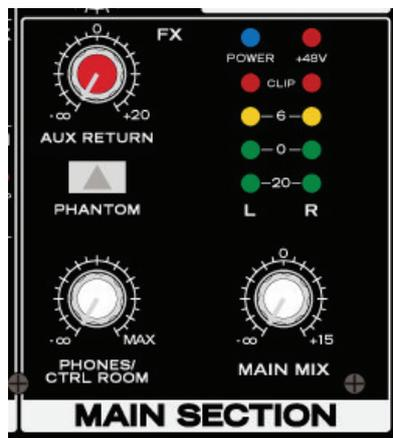
Fig. 2.4: Elementos de control de la sección principal.
