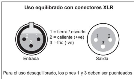
Fig. 4.1: Conexiones XLR
