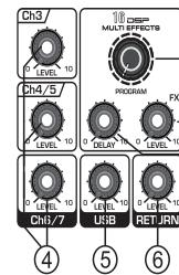
**1.[PROGRAM]** Controlador, seleccione entre 16 tipos de efectos digitales internos, proporcione la misma señal al estéreo L y R.
