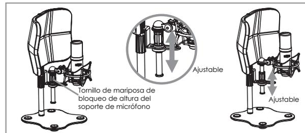
Afloje el tornillo de bloqueo de altura del soporte del micrófono en el soporte del micrófono de extensión con rosca (D), puede ajustar verticalmente la altura del micrófono por su propia voluntad. Hasta que el micrófono esté en la posición correcta, puede fijar el tornillo de mariposa de bloqueo de altura del soporte del micrófono.
