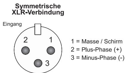
Um eine XLR-Verbindung unsymmetrisch anzuschließen, müssen Pin 1 und 3 gebrückt werden.
