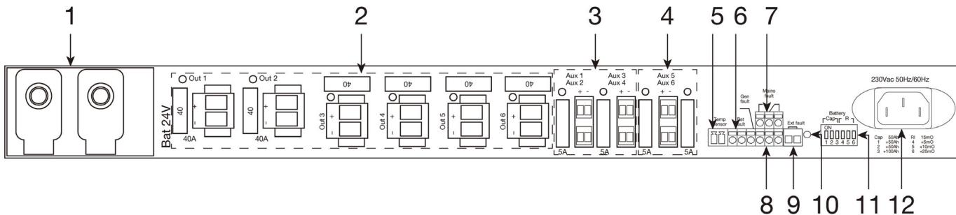
1.- Bornes pour la connexion de la batterie de 24 V, type VRLA-AGM. La charge minimum que peut avoir la batterie pour un fonctionnement correct est de 22 V, si les appareils connectés ne nécessitent pas un voltage plus élevé.
