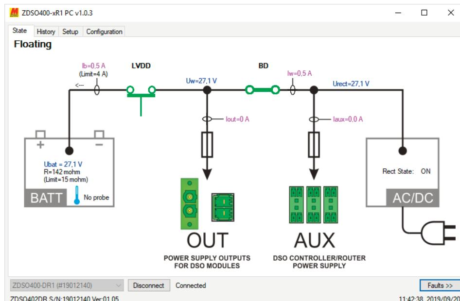
**LVDD** (Low Battery Disconnecting Device): protege contra uma descarga total da bateria.
