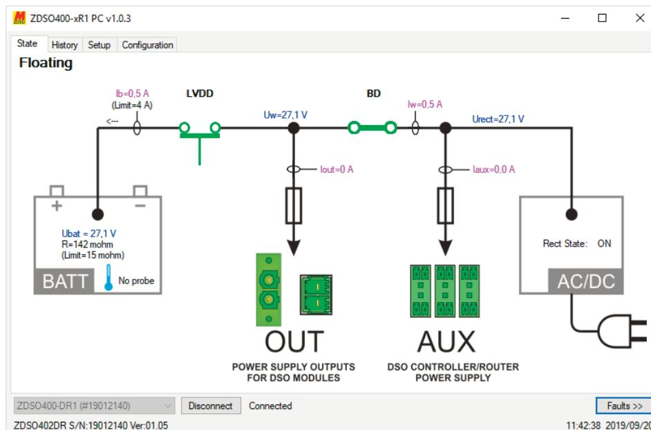
**LVDD** (Low Battery Disconnecting Device) : protège contre une décharge totale de la batterie.
