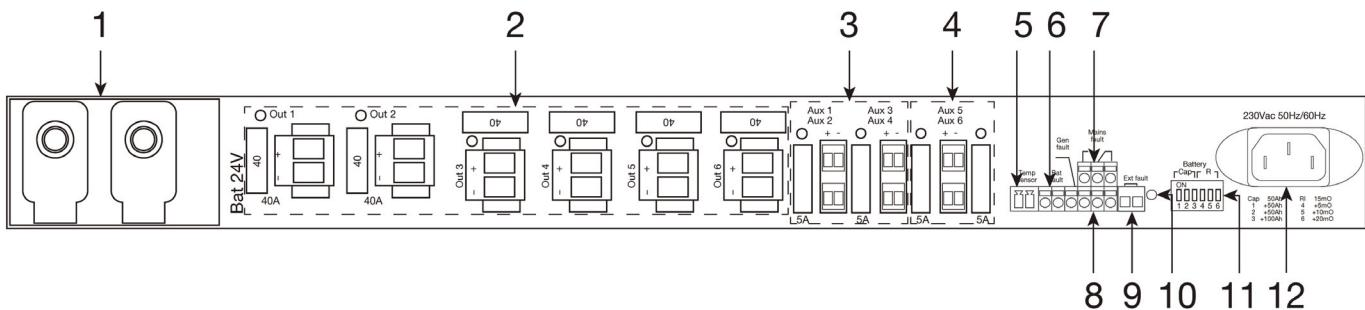
1.- Bornes para ligação da bateria de 24V, tipo VRLA-AGM. A carga mínima que pode ter a bateria para um correto funcionamento é 22V sempre que os equipamentos ligados não requerem mais voltagem.
