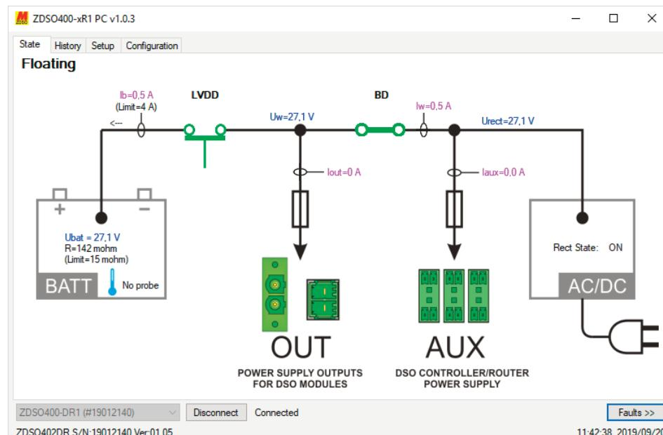
**LVDD** (Low Battery Disconnecting Device): protege contra una descarga total de la batería.
