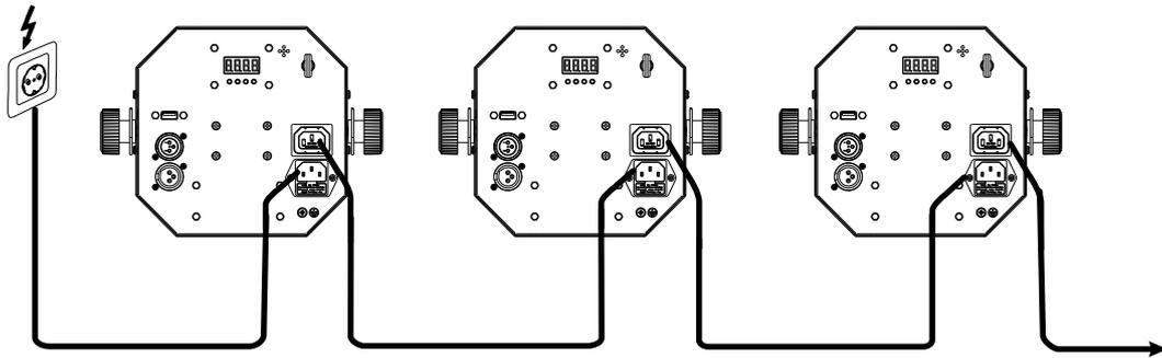
Das Gerät verfügt über ein Schaltnetzteil, das eine Netzspannung zwischen 100 und 240 Volt erlaubt.
