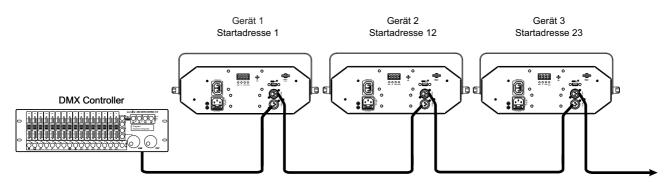
Für die Ansteuerung des Geräts per DMX512 ist eine Datenverbindung notwendig. Das Gerät verfügt dazu über 3-polige XLR-Anschlüsse.
