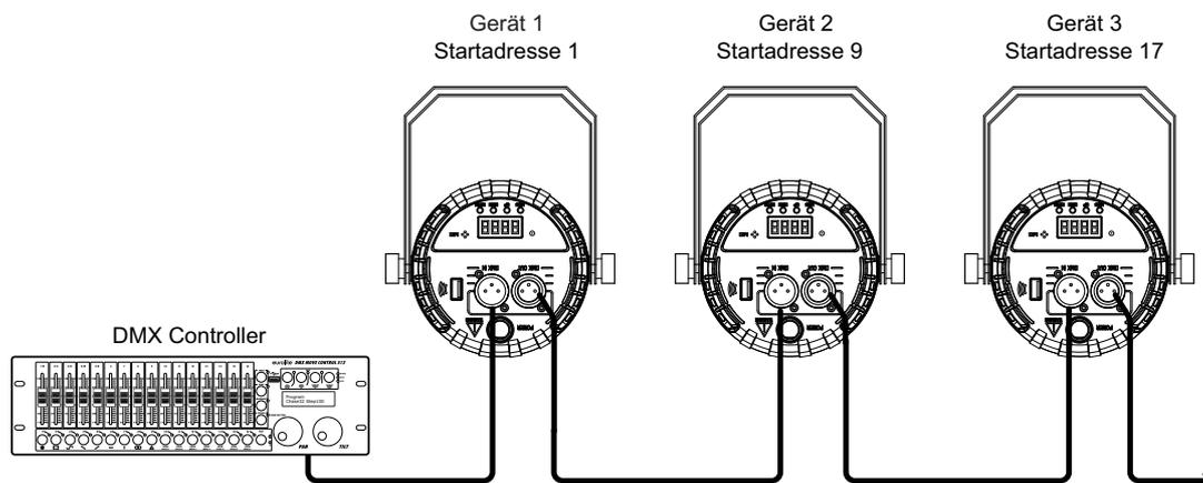
Für die Ansteuerung des Geräts per DMX512 ist eine Datenverbindung notwendig. Das Gerät verfügt dazu über 3-polige XLR-Anschlüsse.
