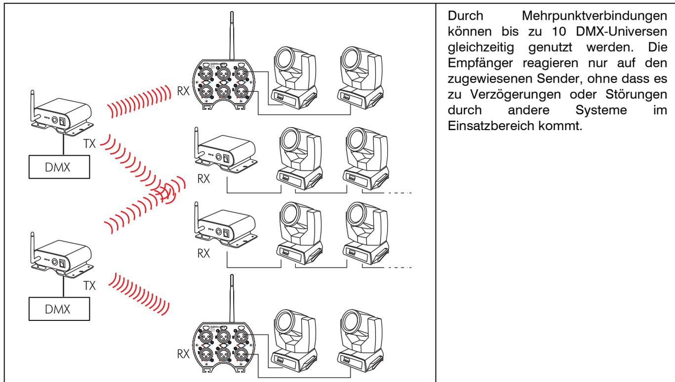
Durch Mehrpunktverbindungen können bis zu 10 DMX-Universen gleichzeitig genutzt werden. Die Empfänger reagieren nur auf den zugewiesenen Sender, ohne dass es zu Verzögerungen oder Störungen durch andere Systeme im Einsatzbereich kommt.
