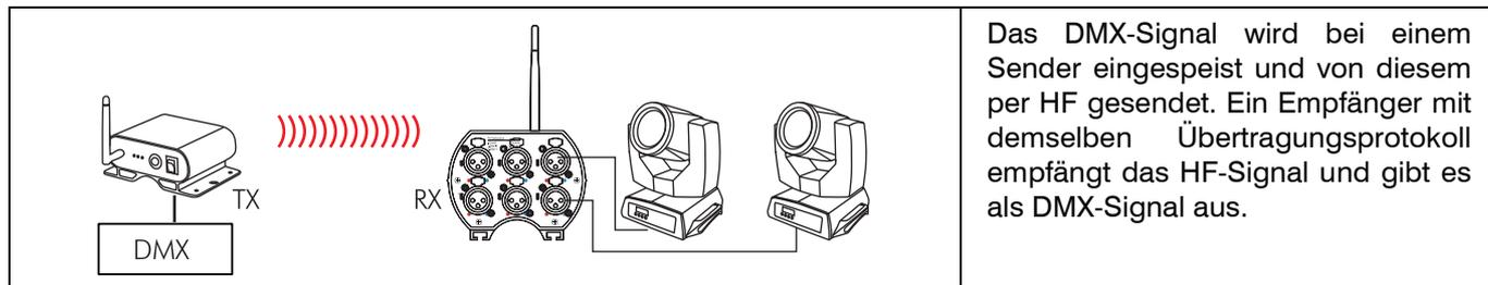
Das DMX-Signal wird bei einem Sender eingespeist und von diesem per HF gesendet. Ein Empfänger mit demselben Übertragungsprotokoll empfängt das HF-Signal und gibt es als DMX-Signal aus.
