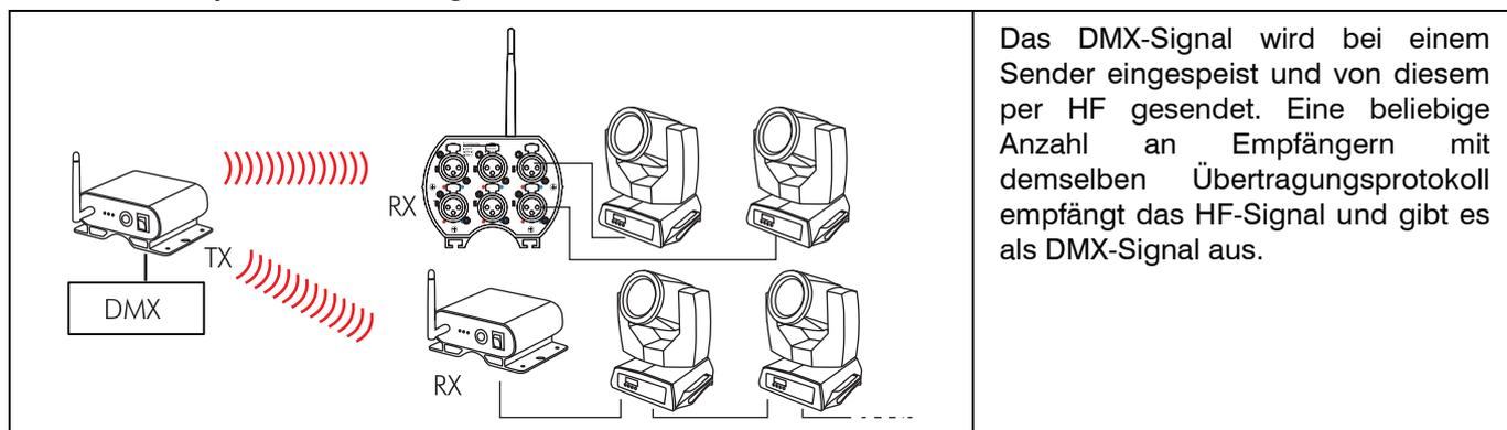
Das DMX-Signal wird bei einem Sender eingespeist und von diesem per HF gesendet. Eine beliebige Anzahl an Empfängern mit demselben Übertragungsprotokoll empfängt das HF-Signal und gibt es als DMX-Signal aus.
