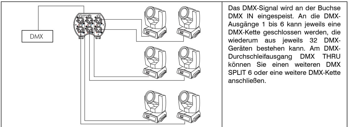
Das DMX-Signal wird an der Buchse DMX IN eingespeist. An die DMX-Ausgänge 1 bis 6 kann jeweils eine DMX-Kette geschlossen werden, die wiederum aus jeweils 32 DMX-Geräten bestehen kann. Am DMX-Durchschleifausgang DMX THRU können Sie einen weiteren DMX SPLIT 6 oder eine weitere DMX-Kette anschließen.
