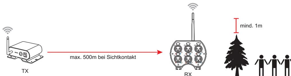
Die maximale Distanz zwischen Sender und Empfänger ist während des Betriebs abhängig von den Umgebungsbedingungen. Für eine optimale Datenübertragung sollte zwischen Sender und Empfänger Sichtverbindung bestehen und sie sollten sich mindestens 1 m über dem Publikum, Bäumen und anderen Hindernissen befinden.
