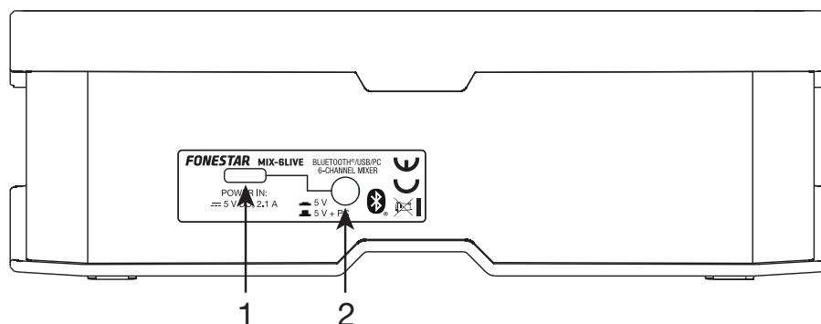
1.- Alimentation et entrée PC. Si un PC est connecté avec un câble USB, cette connexion sert à l'entrée et à la sortie audio ou au contrôle du périphérique USB connecté. Connecteur USB-C.
