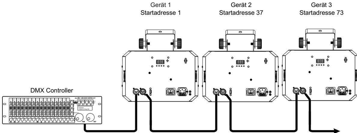
Für die Ansteuerung des Geräts per DMX512 ist eine Datenverbindung notwendig. Das Gerät verfügt dazu über 3-polige XLR-Anschlüsse.
