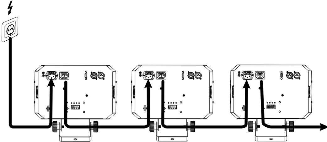
Das Gerät verfügt über ein Schaltnetzteil, das eine Netzspannung zwischen 100 und 240 Volt erlaubt.
