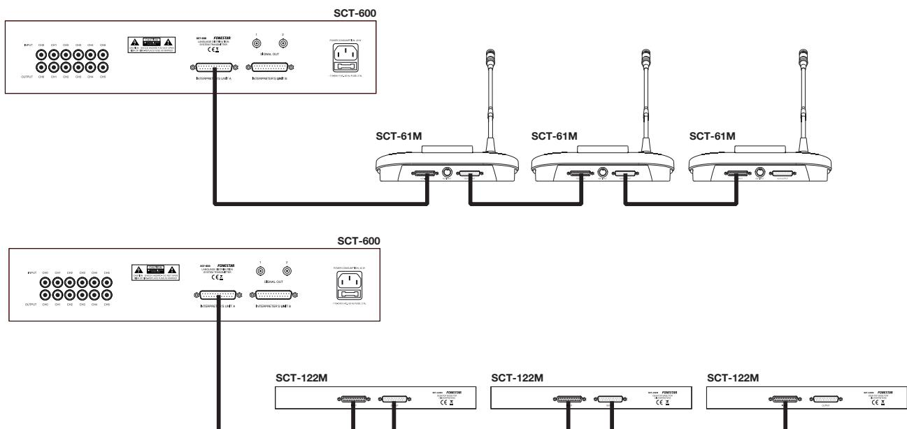
Estos equipos se suministran con un cable DB25 de 10 metros de longitud que puede soportar hasta 5 unidades de traducción conectadas en cascada. Aumentando esta longitud no se puede asegurar el correcto funcionamiento de 5 unidades.
