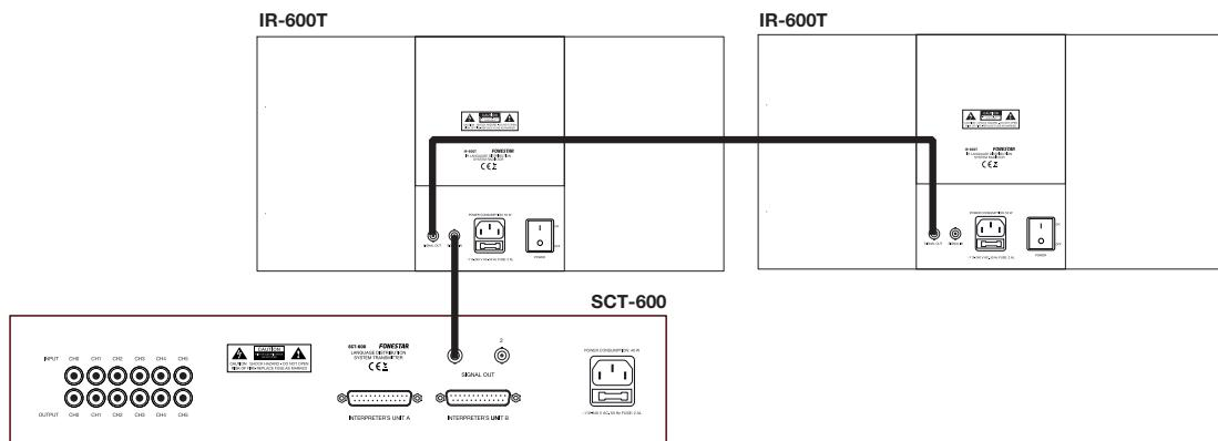
Estes equipamentos são fornecidos com um cabo BNC de 10 metros de comprimento.
