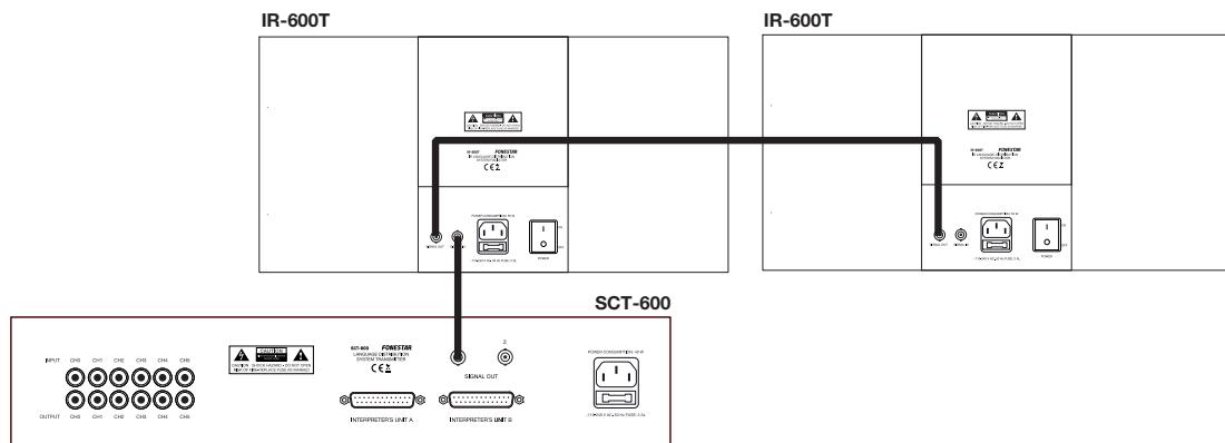
Ces appareils sont fournis avec un câble BNC de 10 mètres de long.
