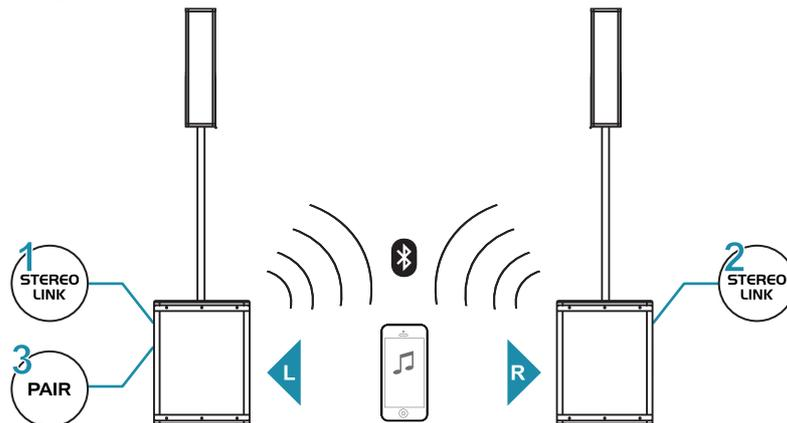
Durch die integrierte TWS-Funktion (True Wireless Stereo) lassen sich zwei ROD-Säulensysteme per Bluetooth koppeln. Der linke und rechte Audiokanal wird dabei getrennt und ohne Verzögerung in Stereo über beide Säulensysteme wiedergegeben.
