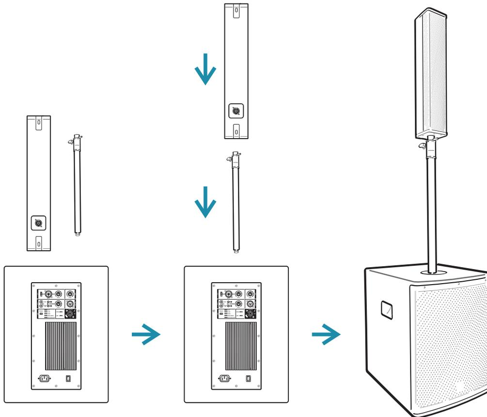
Befestigen Sie die Teleskopstange auf der Oberseite der Subwooferbox und stecken Sie das Säulenmodul darauf. Stellen Sie dabei die Höhe möglichst so ein, dass sich die unteren Lautsprecher des Säulenmoduls auf Ohrhöhe befinden. Um die Höheneinstellung zu sichern, unbedingt den Sicherungsbolzen in die Teleskopstange einsetzen.
