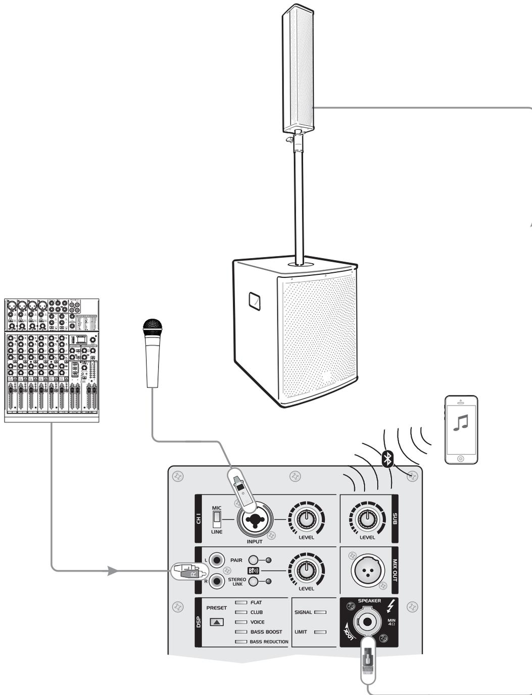
Als Tonquellen können Mikrofone und Audiogeräte mit Line-Pegel angeschlossen werden. Um Störgeräusche zu vermeiden, sollte das PA-System vor dem Herstellen und Trennen von Verbindungen ausgeschaltet sein oder die Ausgangsregler auf Minimum gestellt werden. Für eine gute Klangqualität sollten Sie hochwertige, möglichst kurze Kabel verwenden.
