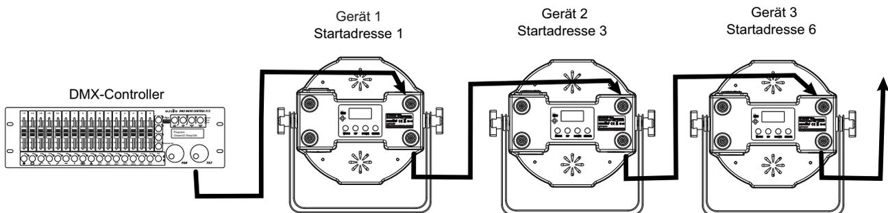
Für die Ansteuerung des Geräts per DMX512 ist eine Datenverbindung notwendig. Das Gerät verfügt dazu über 3-polige XLR-Anschlüsse.
