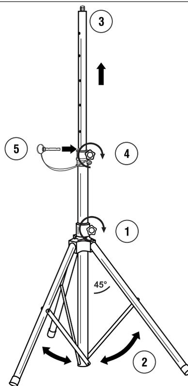
**Öffnen der Stativbeine** - Die Fixierschraube (1) der Stativbeine (2) lösen und diese nach außen ziehen. Die Fixierschraube wieder festziehen.
