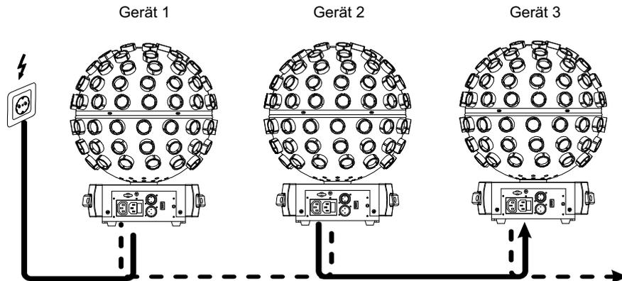
Über den Netzausgang POWER OUT können weitere Geräte mit Strom versorgt werden. Zum Zusammenschalten der Geräte, verbinden Sie immer den Ausgang POWER OUT mit dem Eingang POWER IN des nächsten Geräts bis alle Geräte angeschlossen sind. Passende Netzkabel mit Kaltgerätestecker sind optional erhältlich. Auf diese Weise lassen sich bis zu 8 Geräte bei 230/240 Volt Netzspannung und bis zu 4 Geräte bei 110/115 Volt Netzspannung zusammenschalten.
