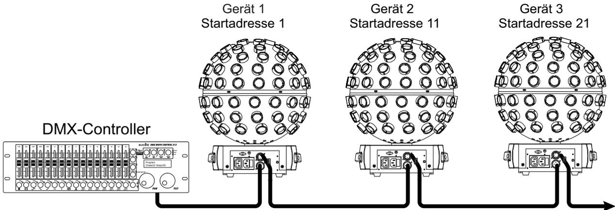
Für die Ansteuerung des Geräts per DMX512 ist eine Datenverbindung notwendig. Das Gerät verfügt dazu über 3-polige XLR-Anschlüsse. Verbinden Sie den Ausgang Ihres Controllers mit dem DMX-Eingang DMX IN des Geräts über ein DMX-Kabel.
