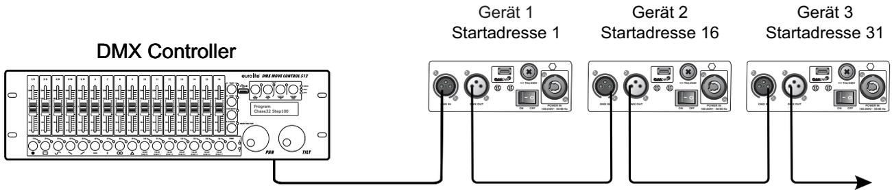
Achten Sie darauf, dass die Adern der Datenleitung an keiner Stelle miteinander in Kontakt treten. Die Geräte werden ansonsten nicht bzw. nicht korrekt funktionieren.
