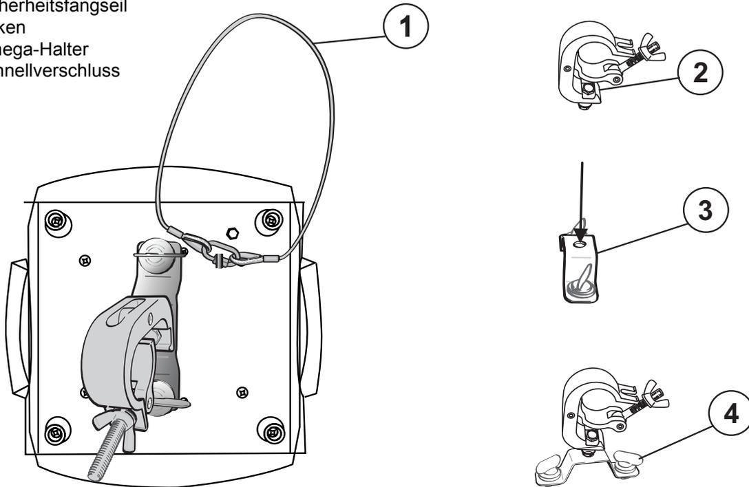
Das Gerät kann auf dem Boden aufgestellt oder an einer Traverse oder einer anderen geeigneten Struktur befestigt werden. Die Montage darf niemals freischwingend erfolgen.
