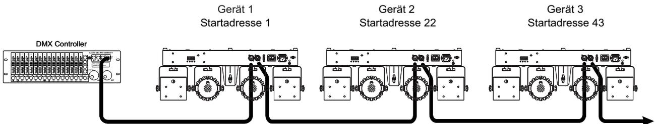
Für die Ansteuerung des Geräts per DMX512 ist eine Datenverbindung notwendig. Das Gerät verfügt dazu über 3-polige XLR-Anschlüsse.
