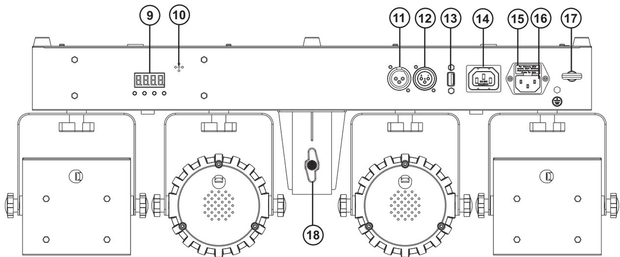
**(9)** LED-Anzeige mit Bedientasten
