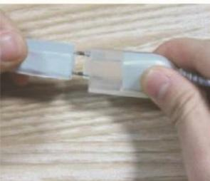
Silikonkleber in den Verbinder des Netzkabels auftragen und dieses anschließen.
