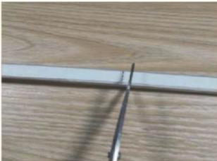
Der Schlauch kann alle 100 cm an der Markierung geschnitten werden.
