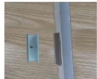
Die Aluminiumkanäle montieren und den Schlauch darin fixieren.
