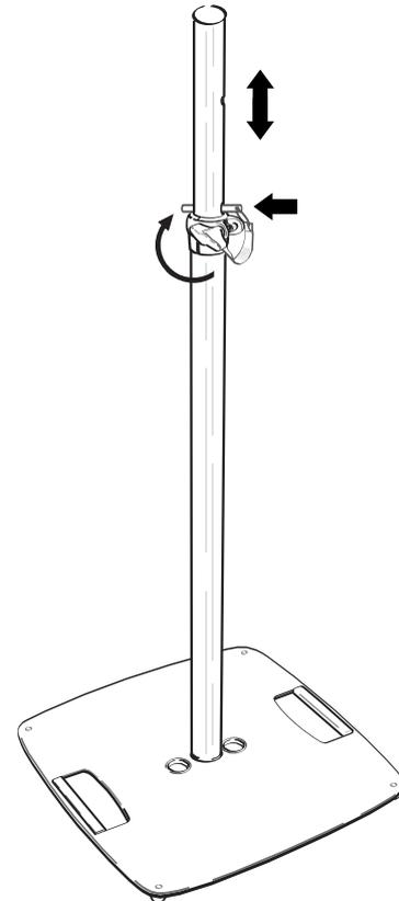
**Montage** - Das Stativrohr in das Gewinde in der Bodenplatte schrauben.
