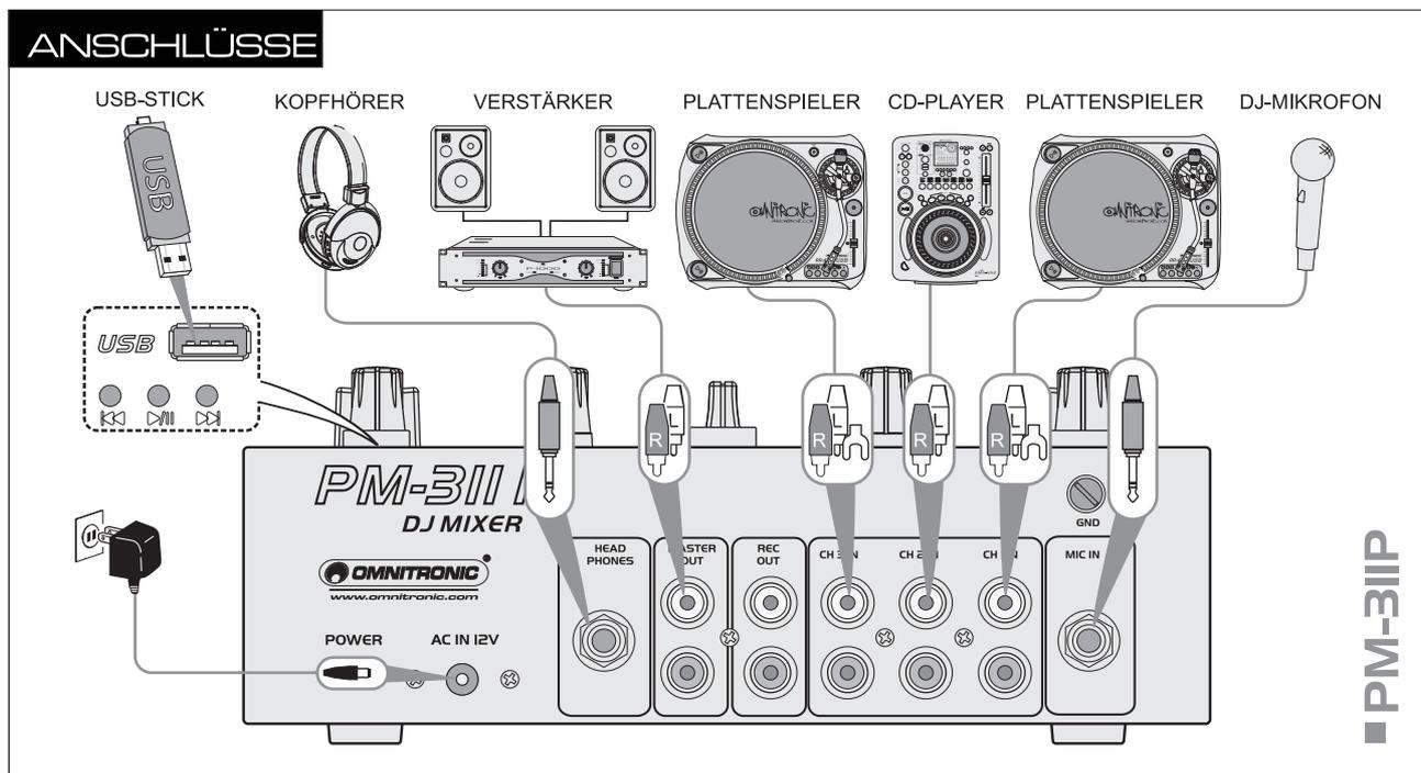
Schalten Sie das Mischpult und die anzuschließenden Geräte vor dem Anschluss bzw. vor dem Verändern von Anschlüssen aus.
